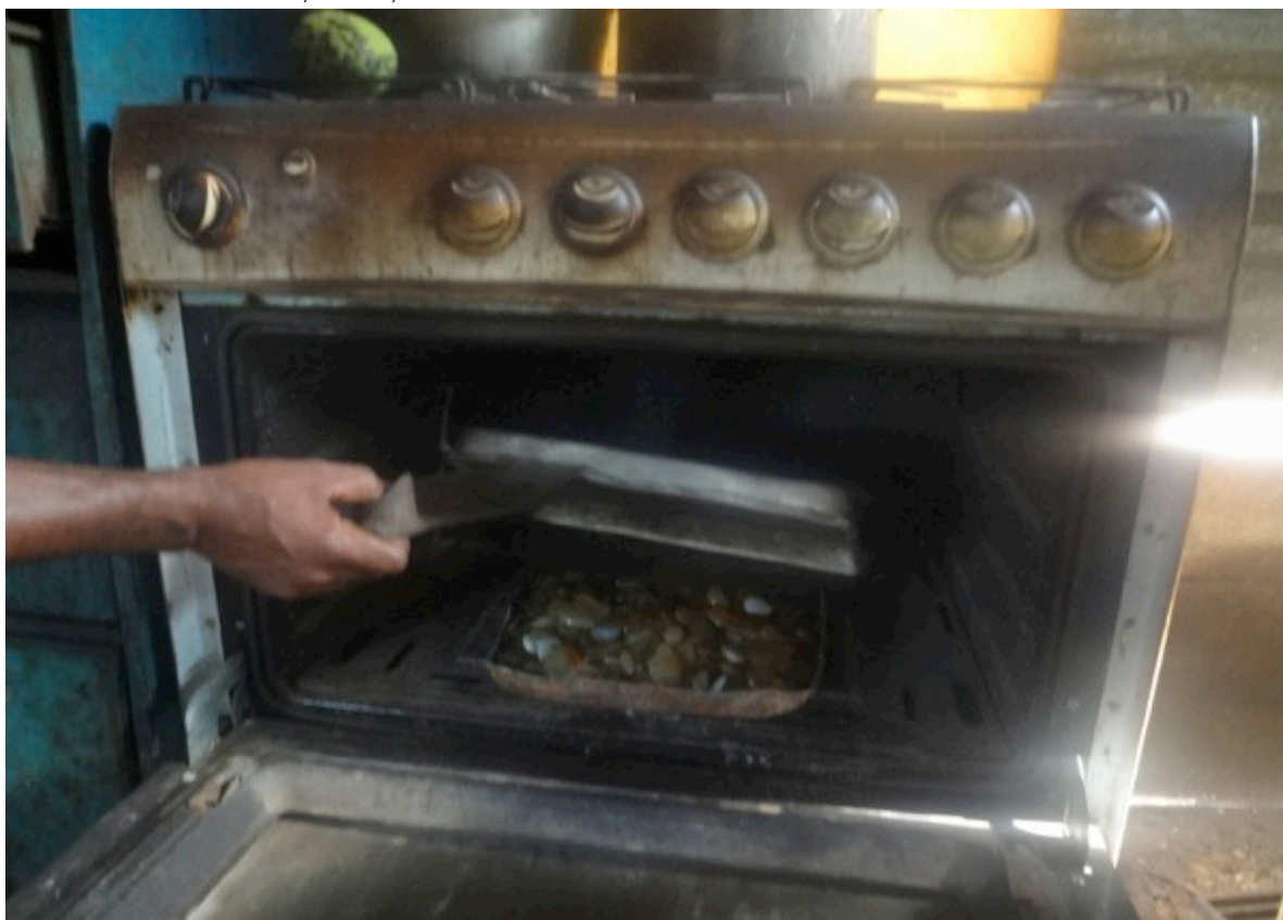
FIGURA 53 – Emprego de um forno à gás doméstico, na etapa de coloração FONTE: Zerlotini da Silva; Moura, 2012
