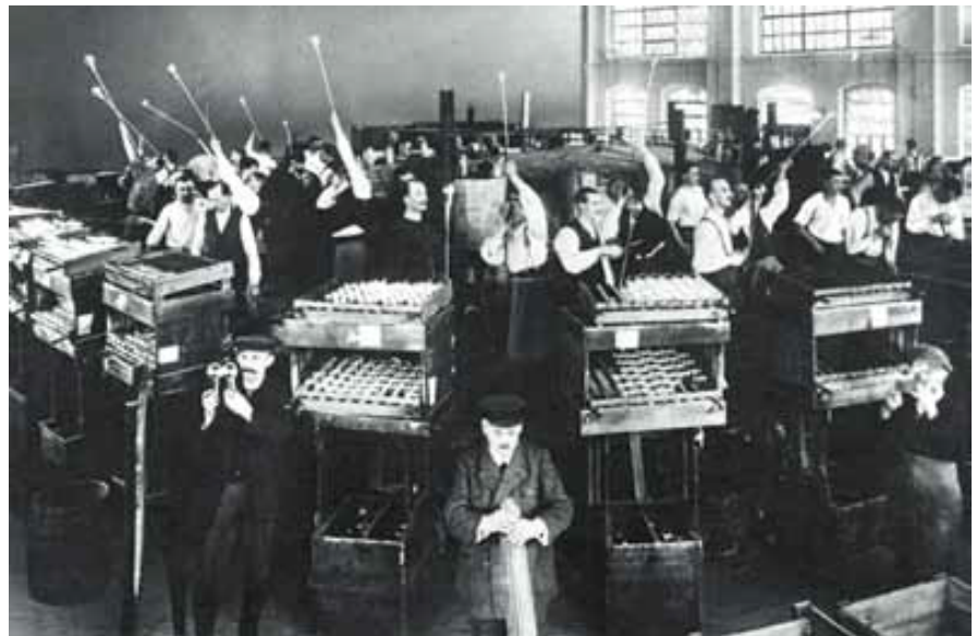
FIGURA 09 – Sopradores de vidro na fábrica de lâmpada elétrica da empresa na Schlegelstrasse, 26, Berlim FONTE: AEG, 2003
